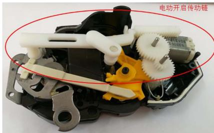
图9 新型电动开启运动链实物模型
